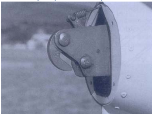
Рис.6: буксировочный крюк Aerazur
